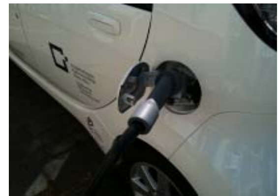
DC-Schnellladung auf dem Betriebsgelände der Stadtwerke Offenbach Holding GmbH
